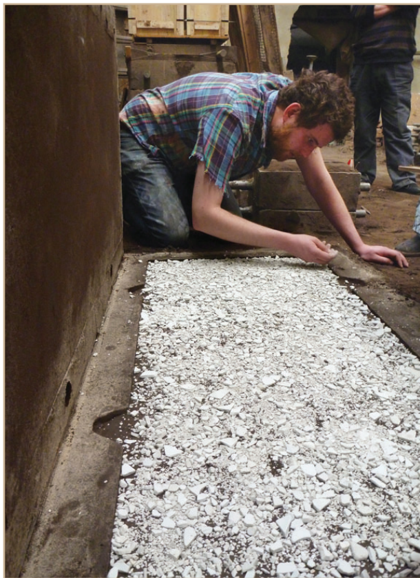
Илл. 4. Процесс изготовления фарфорово-алюминиевых панелей. Recycled China
